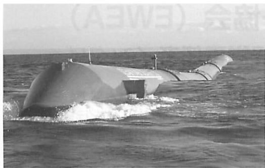
ポルトガルで実用化された波力発電システム (イギリス:ペラミス・ウエーブ・パワー社提供)
