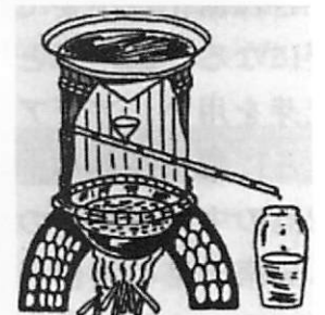
図5 カブト釜式蒸留器 中国型
