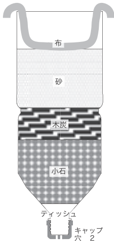
図-2 排水口にティッシュを使つたろ過装置
